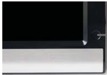
Bouton de mise sous tension
